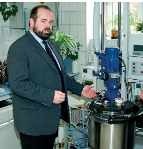
Frank Meister, Chemie-Forschungsleiter des Thüringischen Textil-Forschungsinstituts (TITK), mit einem Rührreaktor zur Herstellung für ALCERU-Spinnlösungen.
