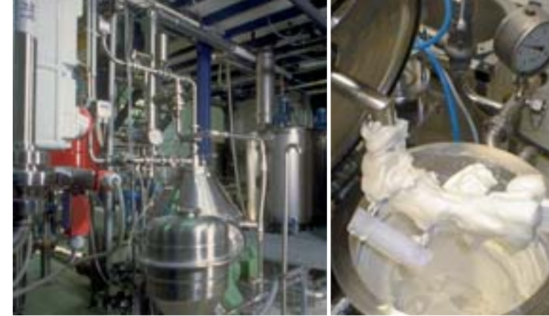
Pilotanlage zur Proteinaufarbeitung
