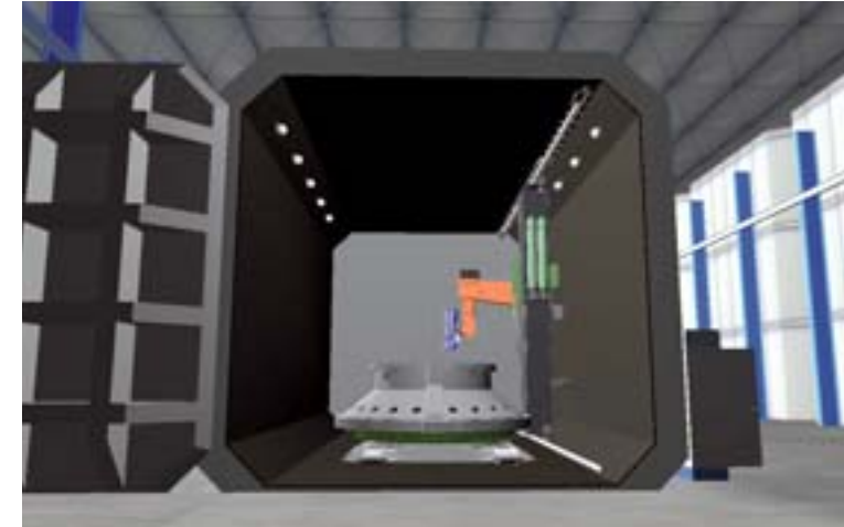
Nutzung der virtual-reality-Technologie zur Simulation von Fügeprozessen an Großbauteilen.
