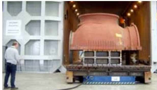
Elektronenstrahlgeschweißtes Turbinengehäuse in der Großkammeranlage in Burg.
