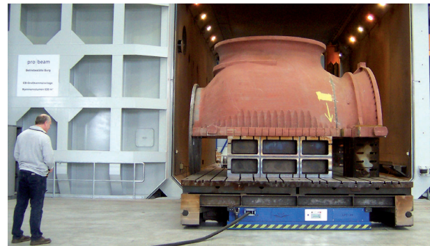
Elektronenstrahlgeschweißtes Turbinengehäuse in der Großkammeranlage in Burg.
