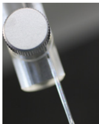
Großes Bild: Analyse-Farbstoff im Probenrohr des ILS-Sauerstoff-Messaufbaus, der erstmals Sauerstoff in Proben rein optisch messen kann, ohne Zellen zu beschädigen.
