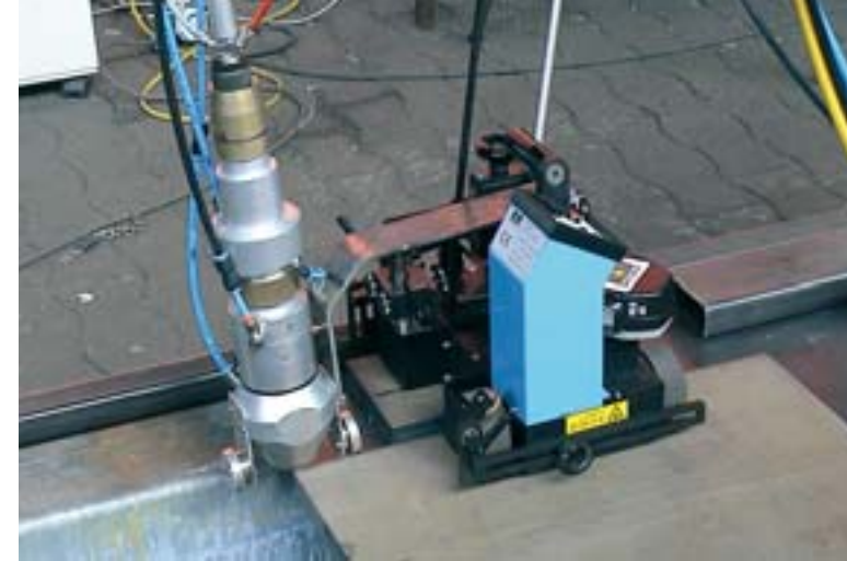
Traktor zum Laserschneiden von Schiffbaustahl
