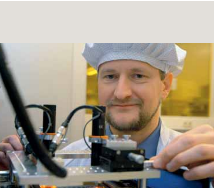
ZIK-Nachwuchsforschungsgruppenleiter Jens Müller testet die neu entwickelte Belichtungseinheit für die mikrometeregenaue 3-D-Strukturierung von Keramikfolien.
