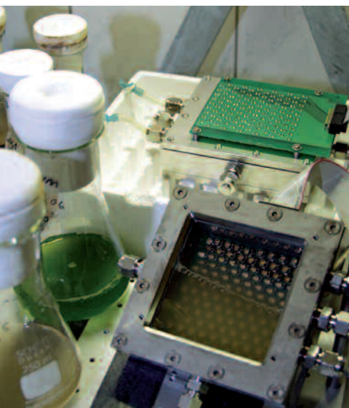
Sauber: Dieser an der Universität Jena entwickelte Photoreaktor entkeimt schmutziges Wasser mittels UV-Licht und Titanoxyd
