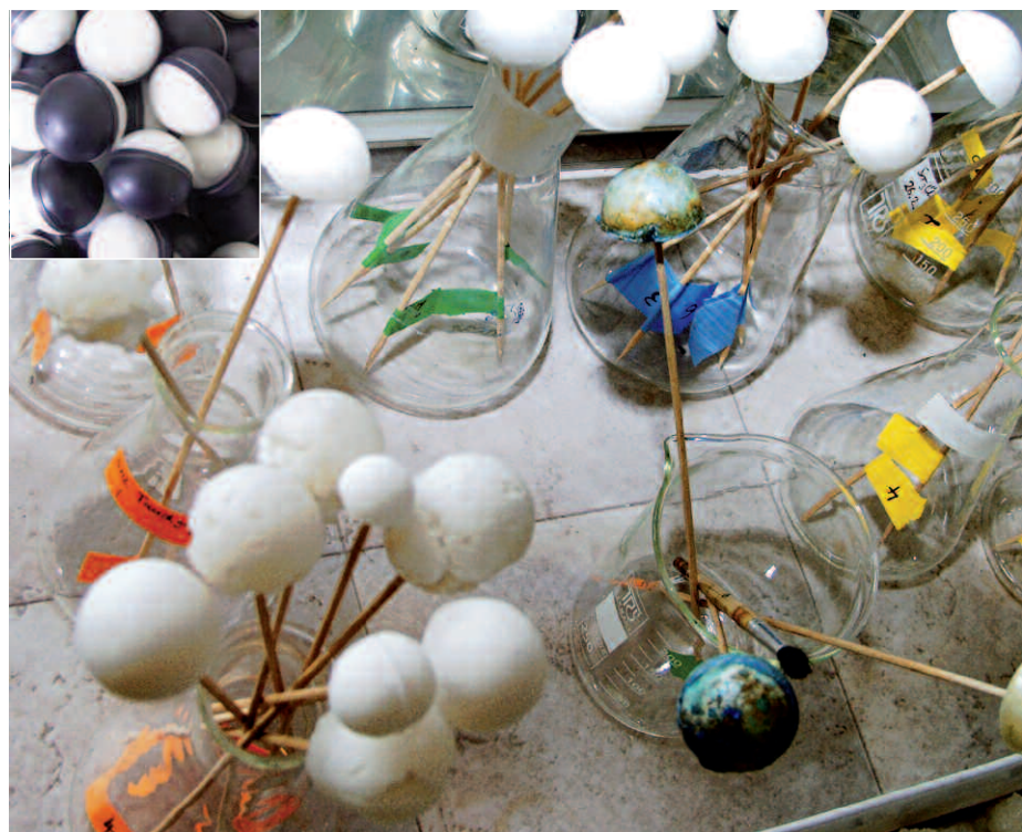
Diese Salzhydratkugeln speichern doppelt soviel Wärme wie Wasser, und geben sie bis zu fünf Wochen lang ab.
