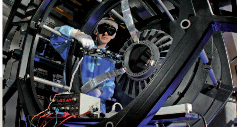
Der Physiker Matthias Schnepf komplettiert die letzte Verstärkerstufe des Hochleistungslasers. Sie wird mit insgesamt 6.000 Laserdioden bestückt sein. Der Laser wird künftig für Sekundenbruchteile eine Billion Watt leisten.
