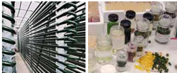
Kleintechnischer Versuchsreaktor für Mikroalgen; Produkte auf der Basis von Algen
