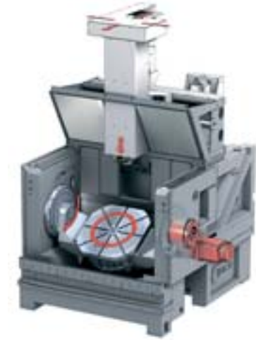
Einsatzmöglichkeiten der HEMONT-Antriebe am Beispiel des CNC-Bearbeitungszentrums C 30 U der Maschinenfabrik Berthold Hermle AG
