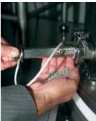
Probenentnahme von „grünen“, ungesinterten Metall-Hohlkugeln aus einem Wirbelschicht-Coater.
