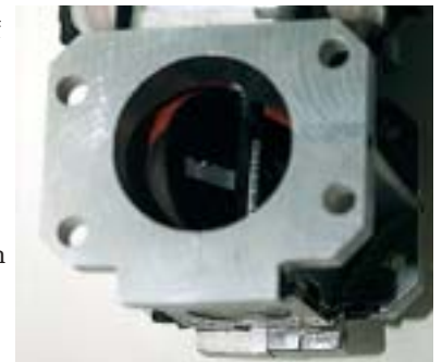
Ein Magnet-Aktor-Ventil, das als sogenanntes Lufttakt-Ventil im Ansaugrohr eines Motors das Drehmoment um bis zu 15 Prozent verbessern kann.
