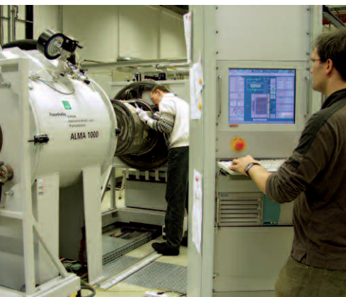
Pilot-Anlage: Fred Fietzke (hinten) vom Dresdner Fraunhofer-Institut für Plasmatechnik inspiziert „Alma“, eine Plasma-Beschichtungsanlage für Schüttgut
