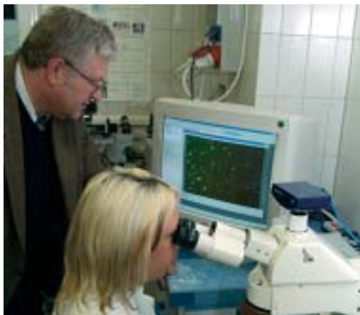
Per Fluoreszenz-Mikroskopie wird im Institut für Nichtklassische Chemie in Leipzig die Aktivität von Sporen beobachtet.
