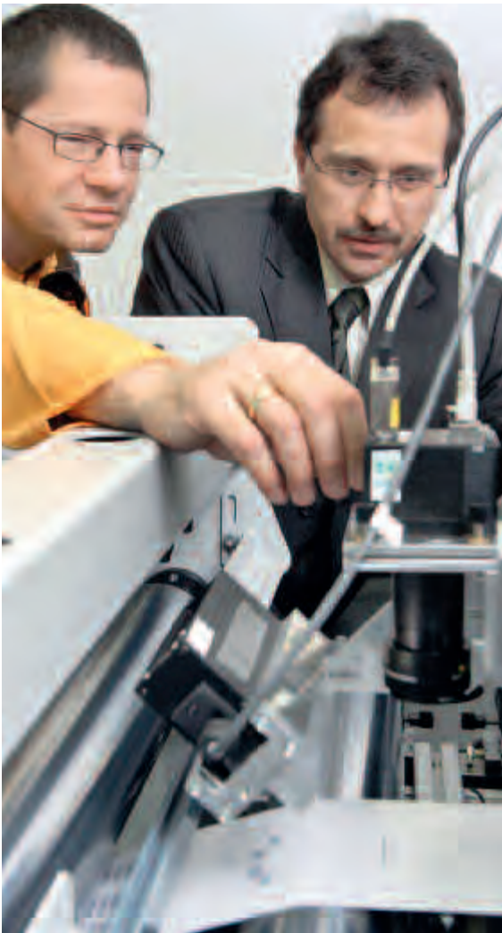
Links: Jens Hänel, Geschäftsführer der 3D-Micromac AG, und ein Mitarbeiter bearbeiten die gedruckten Schicht-Schichten mit einem Fluor-Laser. Unten: gedruckte Schaltungen auf der Offsetrolle.
