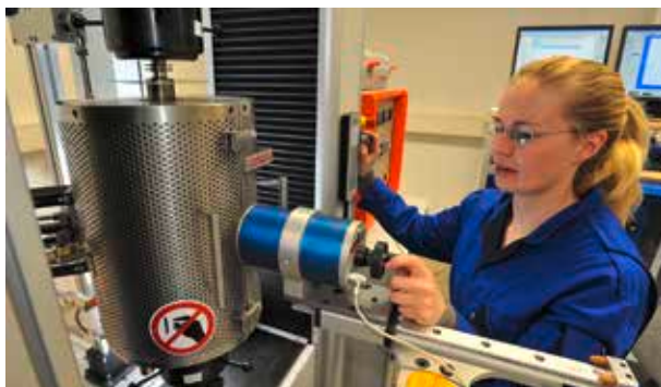
Kennwertermittlung für Bor-Mangan-Stähle durch Warmzugversuche
