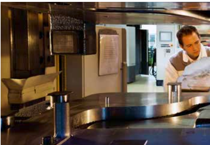
Herstellung eines B-Säulenfußes durch Presshärten
